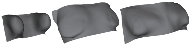
Figura 2. De izquierda a derecha: superficie original (prono); superficie objetivo (supino); resultado de la deformación.
