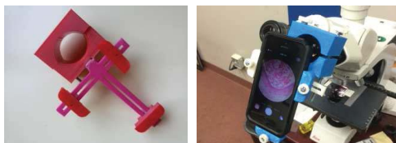
Figura 3. Adaptador universal impreso en 3D
